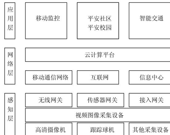
感知层包括各种视频采集设备, 借助各种平台, 采集各种格式的视频信息。网络层将视频采集设备所获取到的视频信息通过网络传输到应用层, 随着互联网技术的发展, 任何信息源都可以连入互联网, 丰富和拓展了视频监控系统的能力和覆盖范围。应用层中的智能视频分析技术是整个系统的核心, 它能够取代人工分析, 自动识别监控画面中的人、车辆和物体, 智能化地研判可能可疑人员和车辆以及变化中的状态, 及时向监控中心人员发出报警信号。
