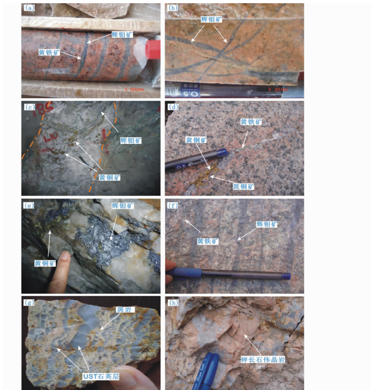
图4 白土营子钼铜矿田内三个矿床主要的矿化类型( a-f )以及岩浆-热液过渡的证据( g、h )相关的典型照片
