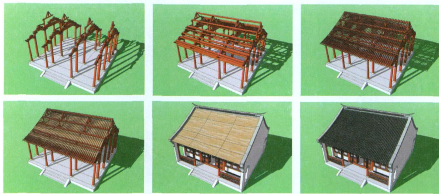
图1 园林建筑木构架的营建过程
