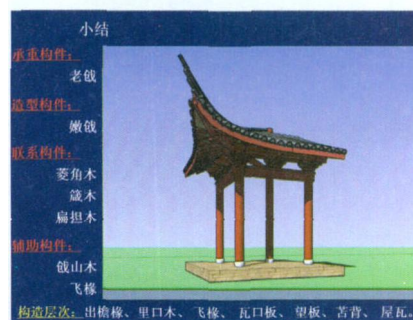
图4 翼角的营造特点与构造方式
