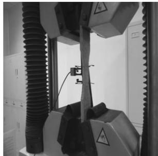
图 2 试件拉伸试验图
