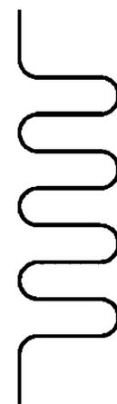
图 2 U 形波纹管平面模型
