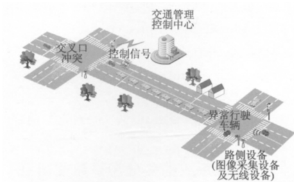
图1 车路协同系统示意图
