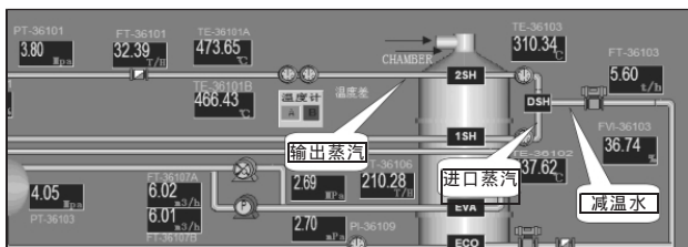
图 1 锅炉蒸汽温度控制系统工艺结构示意图
