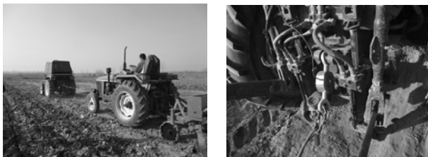
a. 牵引系统工作图 b. 测力计安装位置图 图 3 牵引阻力测试系统
